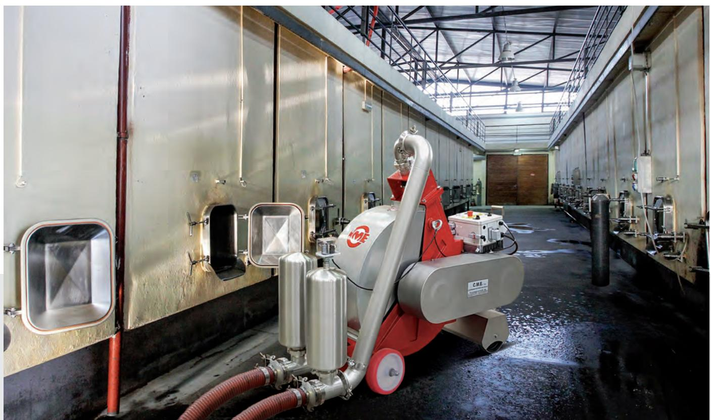
La pompe péristaltique est un type de pompe volumétrique. Le pompage du liquide est obtenu par la compression et la libération d'un tube, par la rotation des rouleaux presseurs. La principale caractéristique de cette pompe est que le fluide pompé n'entre jamais en contact avec les pièces mobiles de la machine. CME propose une large gamme de pompes péristaltiques, à un et à deux tubes, pour des débits allant de 40 à 750 hl/h.
