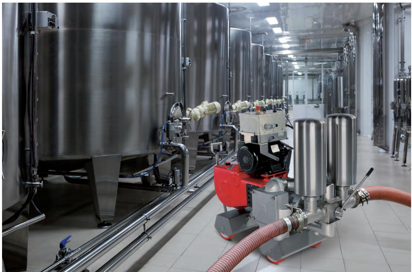
La pompe à piston est un type de pompe volumétrique. Le pompage du liquide est obtenu par le glissement alterné d'un piston à l'intérieur d'un cylindre, les clapets anti-retour permettent le passage du fluide dans le bon sens empêchant son reflux. CME propose une large gamme de pompes à piston, monocylindre et deux cylindres, pour des débits allant de 60 à 1000 hL/h avec une pression de travail à 2/3 bar.
