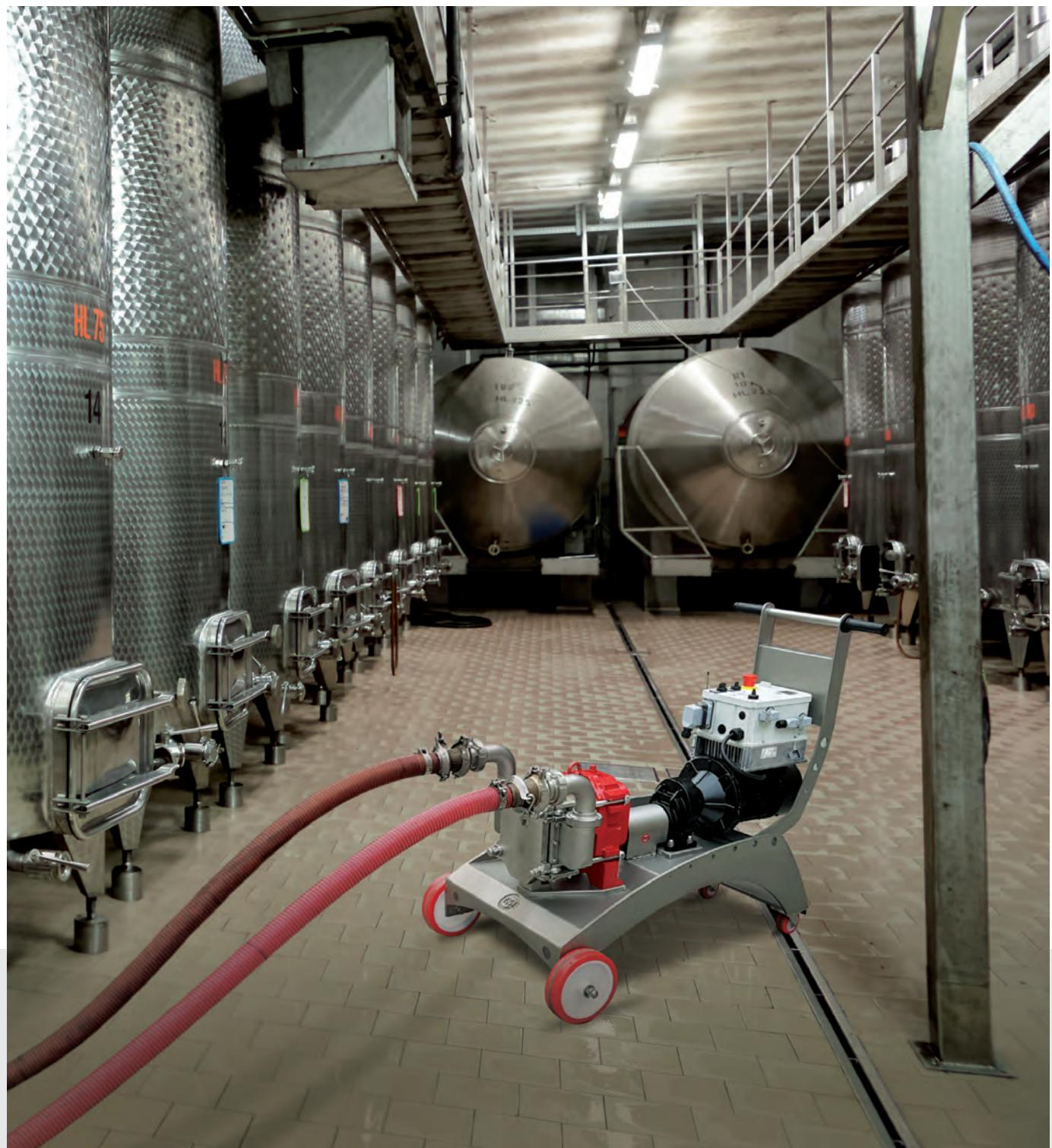
● Les pompes à lobes sont des pompes volumétriques composées d'une chambre formée à l'intérieur de laquelle tournent, sur des axes parallèles et de manière synchrone, deux rotors à lobes. CME propose une large gamme de pompes à lobes avec des débits de 50 à 690 hl/h avec une pression de travail de 3 bar.
