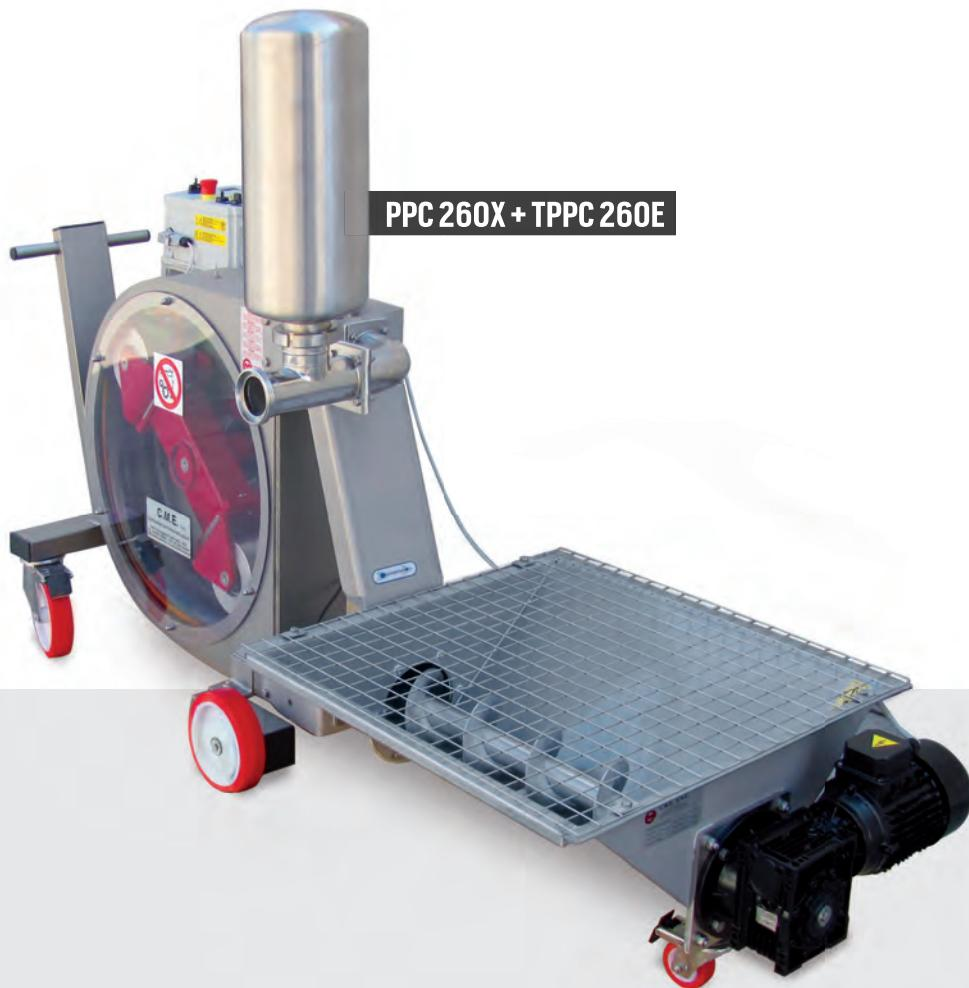
La pompa peristaltica è un tipo di pompa volumetrica. Il pompaggio del liquido è ottenuto dalla compressione e rilascio di un tubo, tramite la rotazione dei rulli pressori. La caratteristica principale di queste pompe è che il fluido pompato non entra mai in contatto con le parti in movimento della macchina. CME offre una vasta gamma di pompe peristaltiche, monotubo e bitubo, per portate da 40 fino a 750 hl/h.
