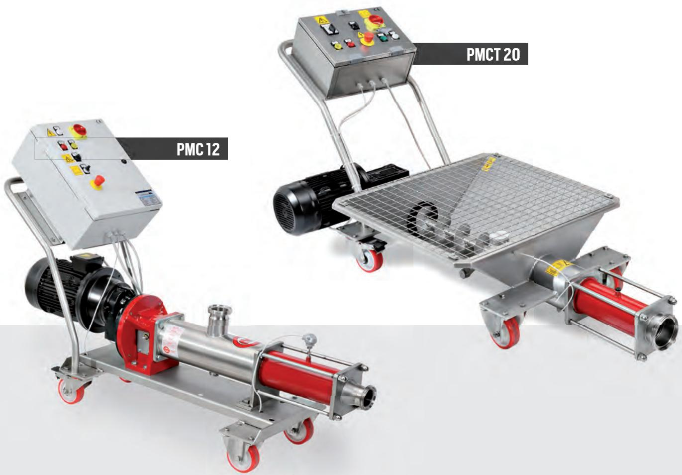
La pompa monovite è un tipo di pompa volumetrica caratterizzata dalla presenza di un rotore che ruota all'interno dello statore fisso. Il moto relativo tra di essi genera delle camere all'interno delle quali il fluido viene inglobato per poi essere pompato.
