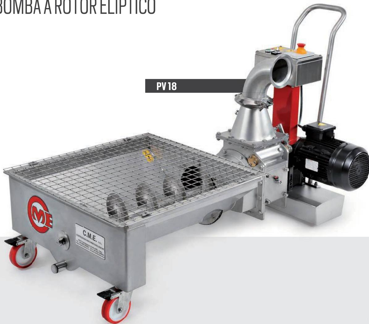
La pompa a rotore ellittico è una pompa volumetrica, si compone di una coclea che alimenta un rotore di forma ellittica che fa avanzare il prodotto per compressione. Frutto dell'esperienza maturata sul campo per oltre 40 anni, CME offre un'ampia gamma di pompe a rotore ellittico caratterizzate da:
