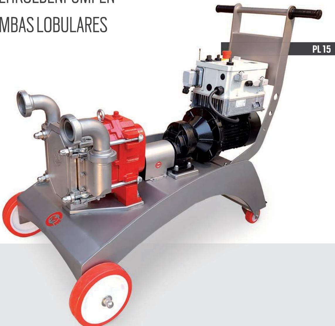
Le pompe a lobi sono pompe volumetriche costituite da una camera sagomata al cui interno ruotano, su assi paralleli ed in modo sincrono, due rotori a lobi.
